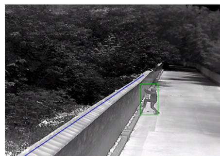
Basierend auf Deep-Learning-Algorithmen bieten Wärmebildkameras eine hocheffektive Erkennung für Linienüberquerung, Einbruch und Bereichsein- und -austritt. Fehlalarme, die durch nicht-menschliche und nicht-fahrzeugbezogene Objekte ausgelöst werden, werden erheblich reduziert.
