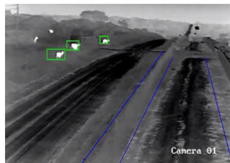
Mittels Wärmebilddetektion können im Vergleich zu herkömmlichen optischen Kameras viel größere Distanzen mit nur wenigen Geräten überwacht werden.
